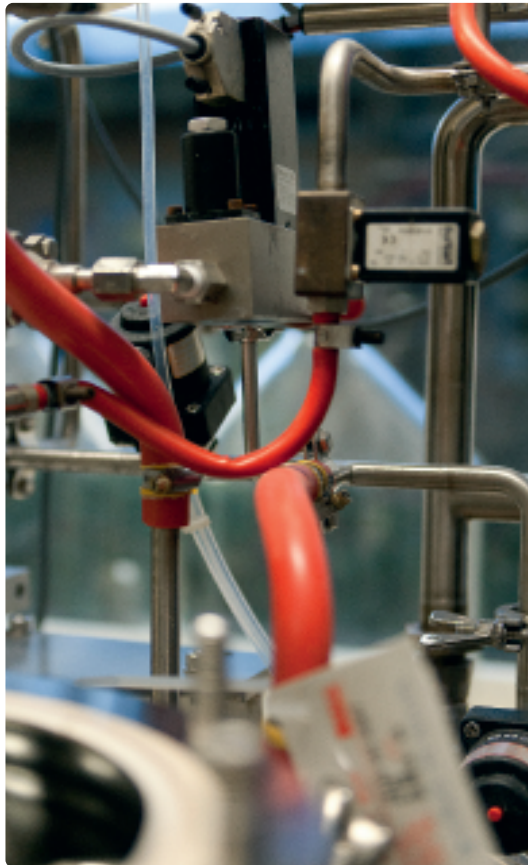
30-Liter-Fermenter zur Kultivierung von Bakterien-Produktionsstämmen.
